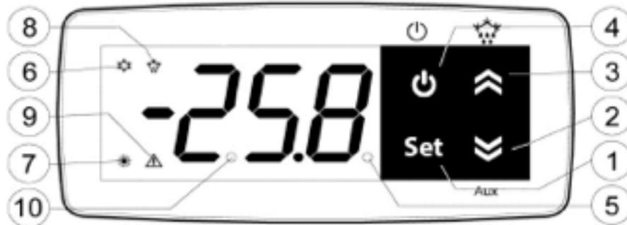
**Taste 1** - SET: Programmierung des Set point (Temp Work) und der Funktionsparameter.
